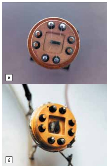
Рис. 9. Образец датчика кислорода на основе SmS: а) полученный золь-гель-методом; б) полученный взрывным методом напыления
