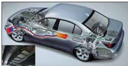
Рис. 6. Термоэлектрические генератор под днищем BMW
